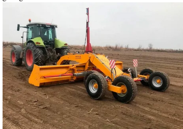
2-rasm. PL-3,5 rusumli lazerli yer tekislagichining gruntga ishlov berish jarayoni.
