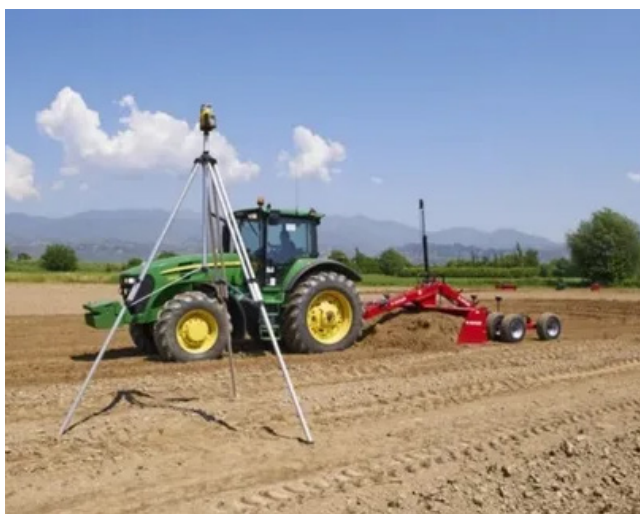
1-rasm. "ALP-AGRO" lazerli yer tekislagichining gruntga ishlov berish jarayoni.
