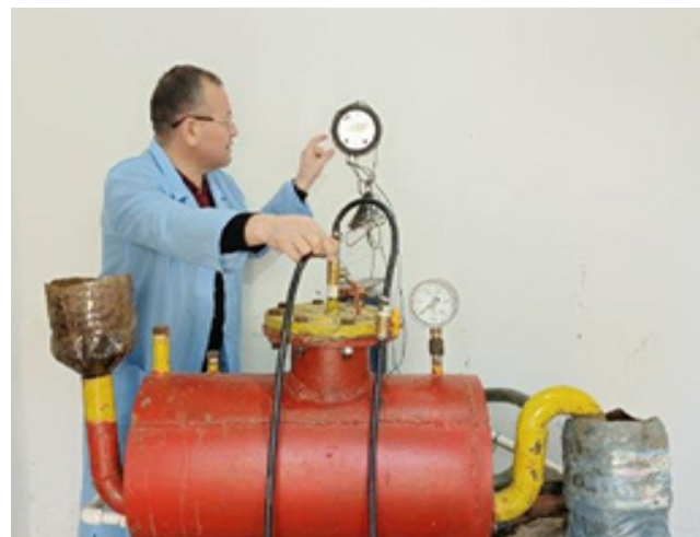
1-расм. Лаборатория қурилмасида парранда органик чиқиндисини анаэроб қайта ишлаш жараёни
