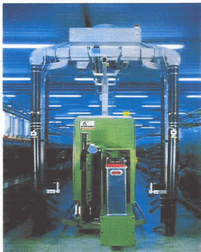
Рис. 6. Общий вид установки Wondercleaner на кольцепрядильной машине RST –1
