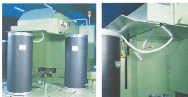
Рис. 4. Автомат смены тазов и автоматический отсекаль ленты.
