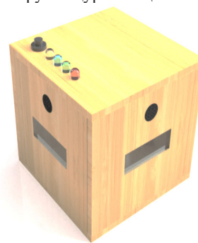
1-расм. Шовқин меъёри ҳақида огоҳлатувчи NAD-1 қурилмасининг умумий кўриниши.
