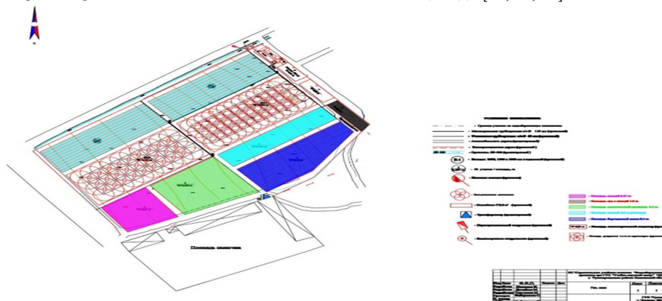
1-расм. Соя ва гулкарамни ёмғирлатиб суғориш схемаси
