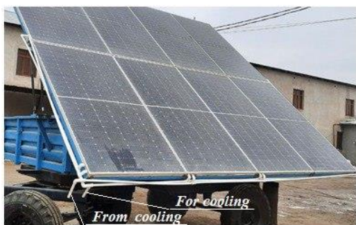
Рис. 6. Мобильная фотоэлектрическая установка: 1 – фотоэлектрические панели; 2 – система охлаждения; 3 – тележка.
