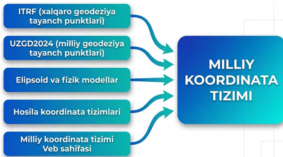
1-rasm. Milliy koordinatalar tizimining geodezik referens asosi arxitekturası
