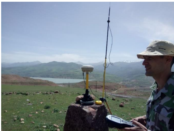
3-rasm. GNSS bazasini hudud atrofidagi davlat geodezik tarmoq punktiga o`rnatish
