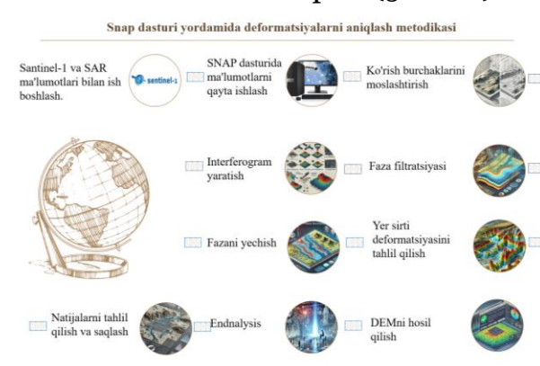
5-rasm. SNAP dasturi yordamida deformatsiyalarni aniqlash metodikasi
