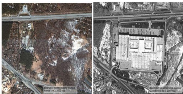
Рис.5. Два космических снимка, выполненные в одном районе местности при повторной съемке, позволяют ускорить составление и обновление топографической карты
