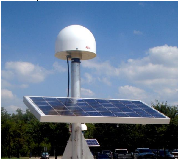
1-rasm. Doimiy baza sifatida ishlab turuvchi VRS bazasi.
