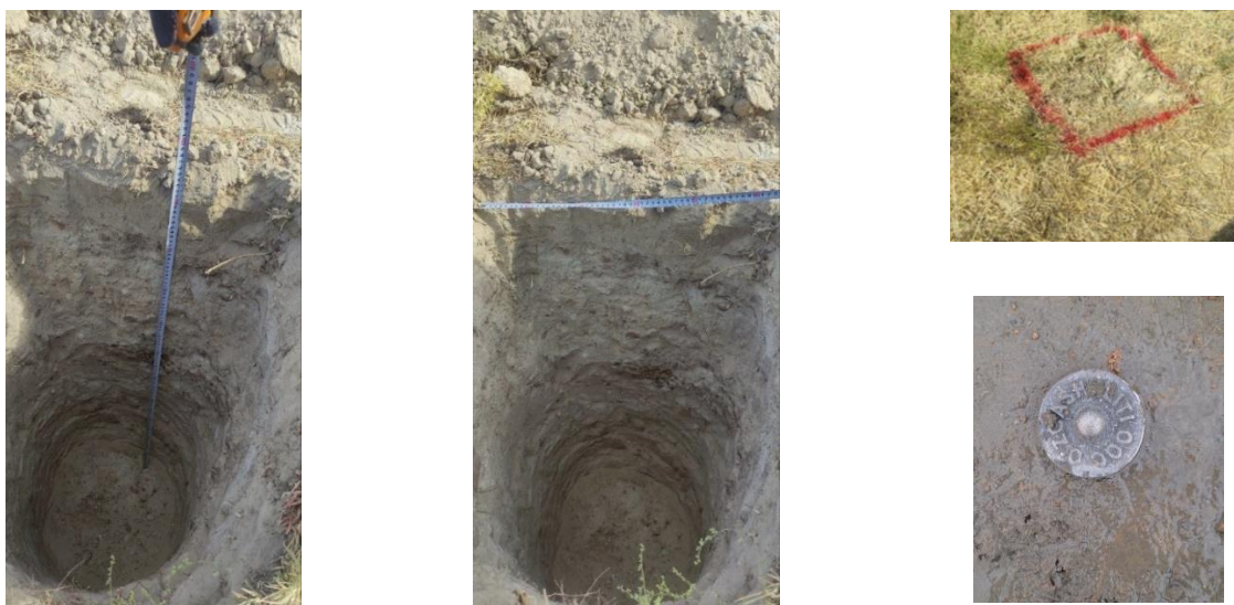
2-rasm. Loyihalangan TGT punktlari uchun 158-tur markazlarini mahkamlash
