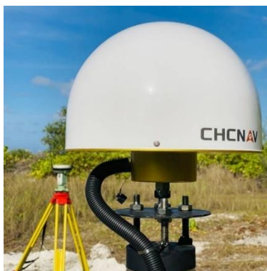
1-rasm. Doimiy baza sifatida ishlovchi VRS (CORS) bazasi.
