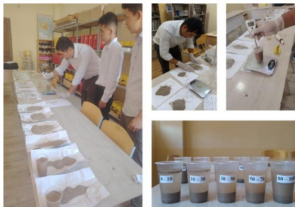
3-rasm Tuproq sho'rlanishini aniqlashda elektr o'tkazuvchanlik aniqlash jarayoni
