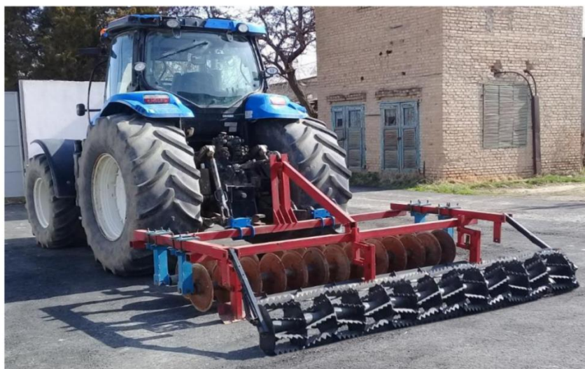
1-rama; 2-diskli g'altakmolalar 2,3-paralelogramm mexanizm; 4-tekislagich; 5-plankali g'altakmola
