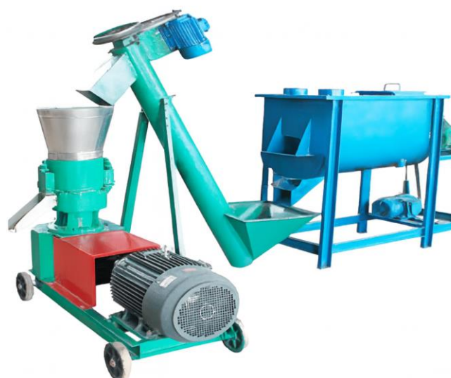
1-rasm. Baliq va parrandalar uchun granula tayyorlash liniyasi
