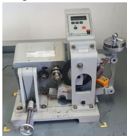
1-rasm. Rezina yedirilishini sinash uskunasi Akron Abrasion Tester.
