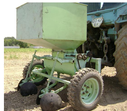
5-rasm. Diskli-shnekli miqdorlagich apparat bilan jihozlangan kartoshka ekish mashinasi.
