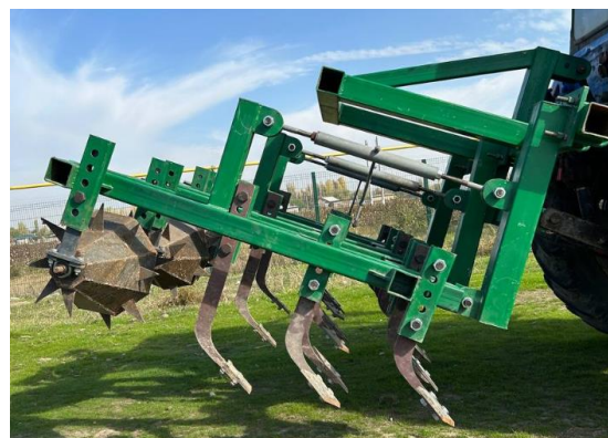
1-rasm. G'o'za qator oralarining tuprog'ini qatlamlab yumshatadigan texnik vositaning konstruksiyasi va tajribaviy nusxasi
