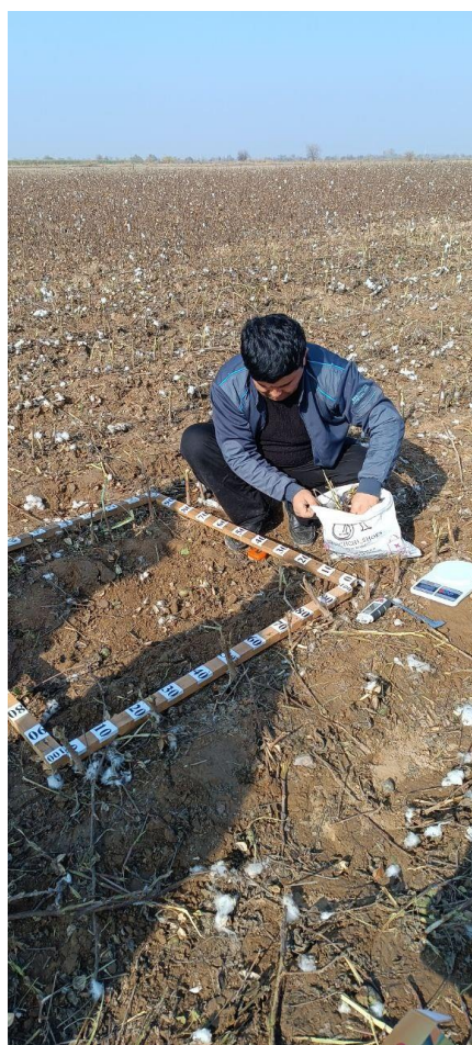
2-rasm. Dalada maydalanigan g'ozapoya bo'lakchalarini fraksiyalarga ajratib, elektron tarozida o'lchash jarayonidan fotolavha.
