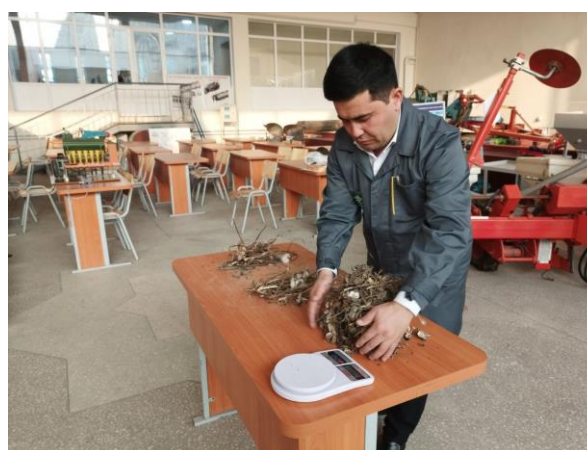
2-rasm. Dalada maydalanigan g'ozapoya bo'lakchalarini fraksiyalarga ajratib, elektron tarozida o'lchash jarayonidan fotolavha.
