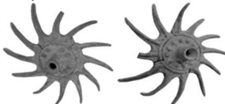
2-расм. Иш жараёнида тез ейилиб-қийшайган ва синиб кетган юлдузчаларнинг умумий кўринишлари.
