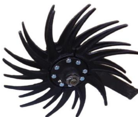
3-расм. Қуйма нинасимон ротацион юлдузчанинг тўлиқ йиғилган ҳолатининг кўриниши.
